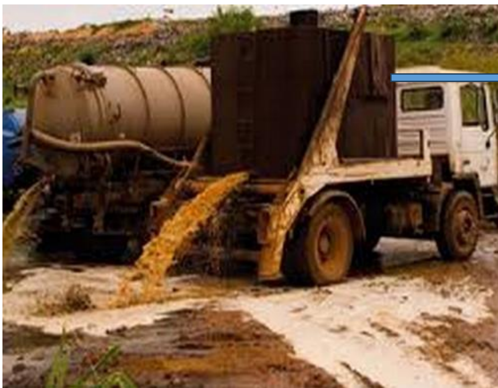
Photo 6 : Réservoir mobile pour stockage des boues de vidange à Dakar au Sénégal
